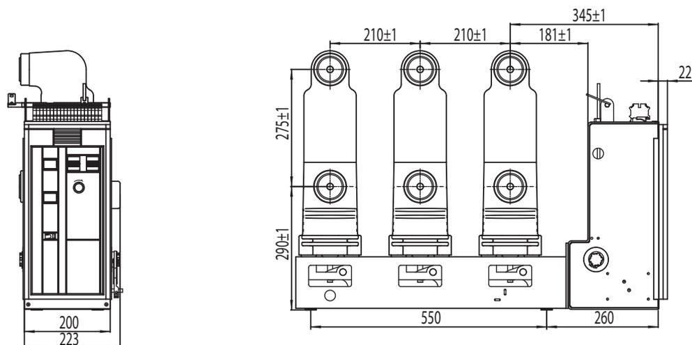
**ВВ 40.5кВ Продольное исполнение, модульный тип привода 350 мм**
