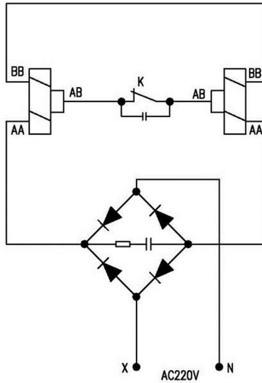
Принципиальная электрическая схема высоковольтного вакуумного контактора серии ВВ(Ф)-7.2
