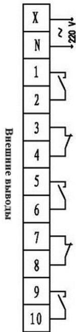
Примечание: нормально разомкнутый, нормально замкнутый узел находится в контакторе в состоянии торможения-отключения
